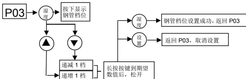
注：AC 电机：001（4 分管），002（6 分管），003（8 分管）；DC 电机（应急开、关风口的长度）：001（1 个位点），002（2 个位点），003（3 个位点）
